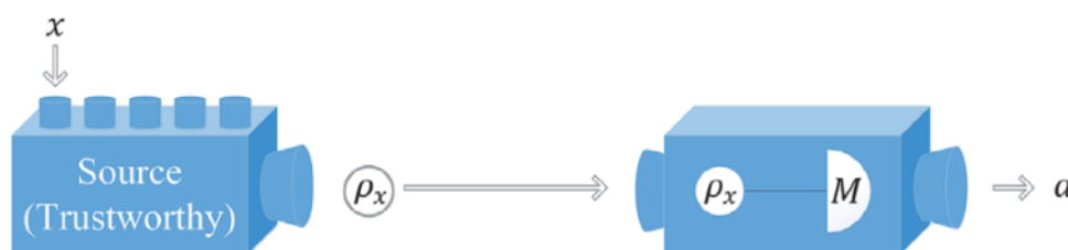
图 6 制备 - 测量型的基于不可信测量设备的量子相干性度量估计方案
